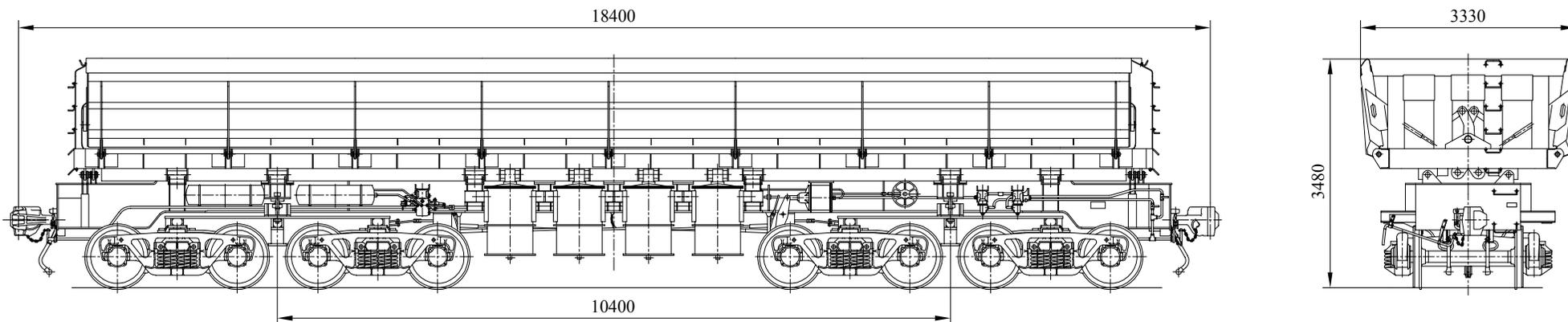
Предназначен для перевозки горной массы плотностью 1,75...4 т/м<sup>3</sup> по промышленным железнодорожным путям горнорудных предприятий. Конструкция рассчитана на прямое падение глыб массой до 4 тонн с высоты 3 метра.
