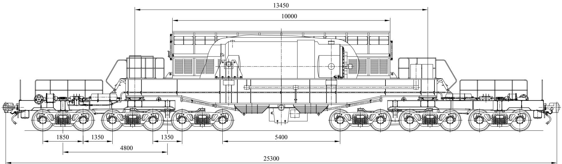
Предназначен для транспортировки контейнера с отработавшим ядерным топливом атомных электростанций по сети железнодорожных дорог.
