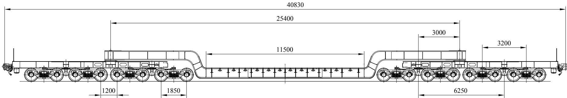
Предназначен для перевозки станин, прессов, шаботов и других крупногабаритных грузов.
