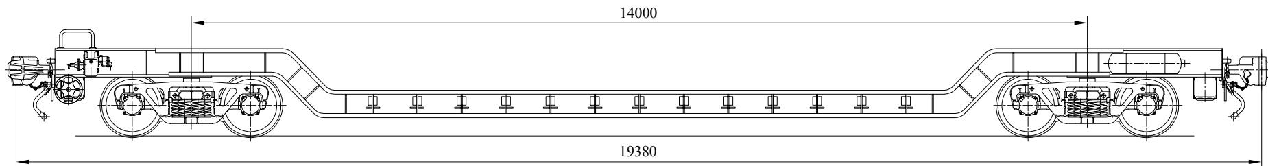
Предназначен для перевозки станин, прессов, шаботов и других крупногабаритных грузов.
