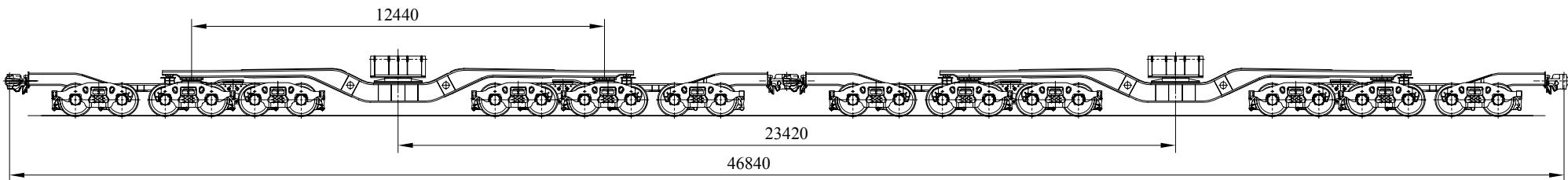
Предназначен для перевозки грузов цилиндрической и плоской формы.
