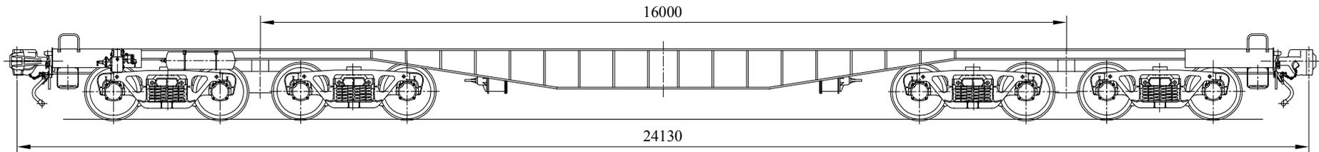
Предназначен для перевозки длинномерных крупногабаритных грузов типа станин, прессов, шахтных барабанов и других грузов.
