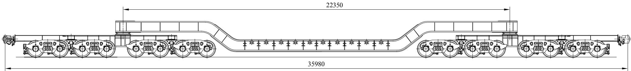
Предназначен для перевозки тяжеловесного длинномерного оборудования по сети железных дорог.
