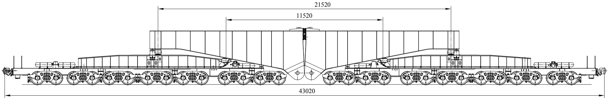
Предназначен для перевозки энергетического и другого оборудования.
