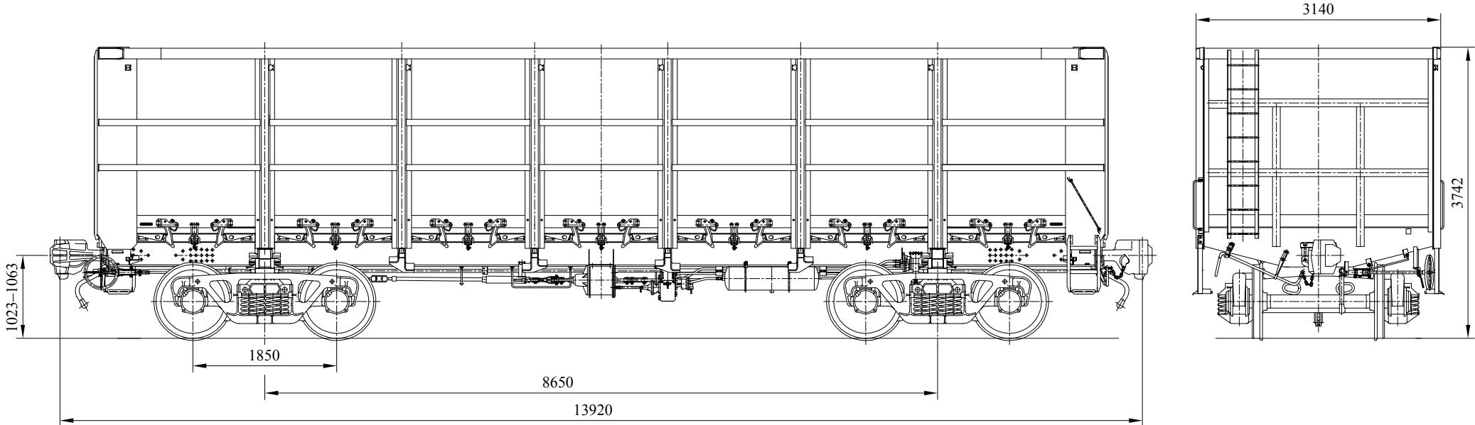
Полувагон предназначен для общесетевого использования при перевозке грузов, не требующих укрытия от атмосферных осадков. Конструкция отличается улучшенным дизайном, усиленными торцовыми и боковыми стенками, применением сталей повышенной прочности. Объем кузова увеличен до 86 м<sup>3</sup>.
