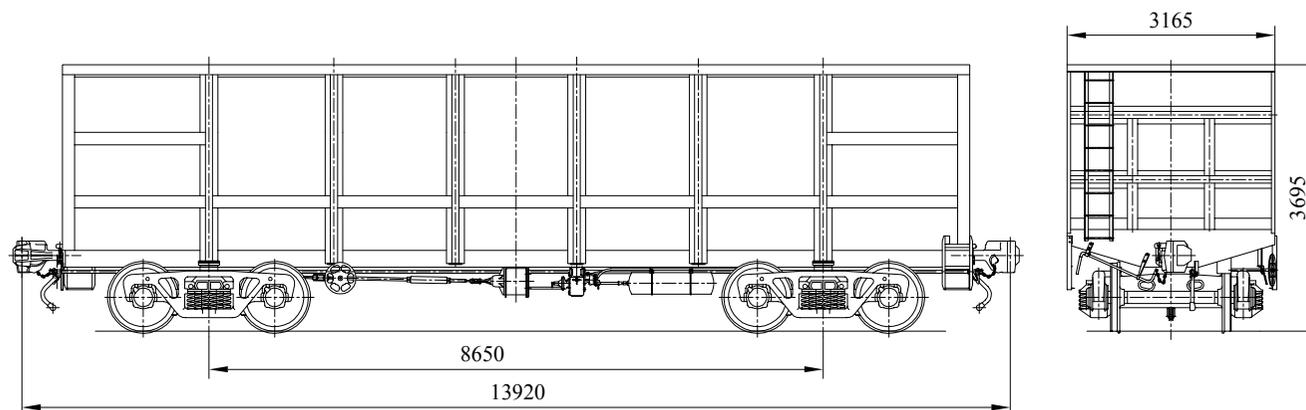
Полувагон предназначен для общесетевого использования при перевозке грузов, не требующих укрытия от атмосферных осадков.
