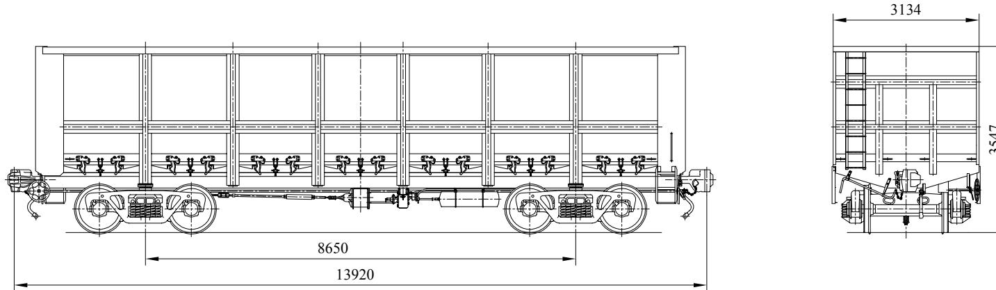
Полувагон предназначен для общесетевого использования при перевозке грузов, не требующих укрытия от атмосферных осадков. Конструкция отличается улучшенным дизайном и усиленными торцовыми и боковыми стенками. Объем кузова увеличен до 85 м<sup>3</sup>.
